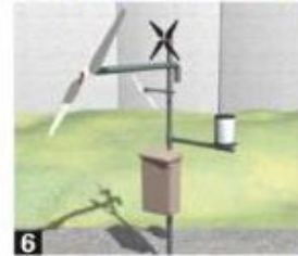
Pluviograf zum Messen und Aufzeichnen der Regenmenge
