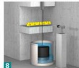
Pendellot zum Messen der Verformung der Staumauer
