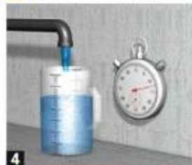
Stoppuhr und Massbecher zum Messen der Sickerwassermenge
