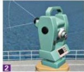
Theodolit (Winkelmesser) zum geodätischen Vermessen der Verformung der Staumauer
